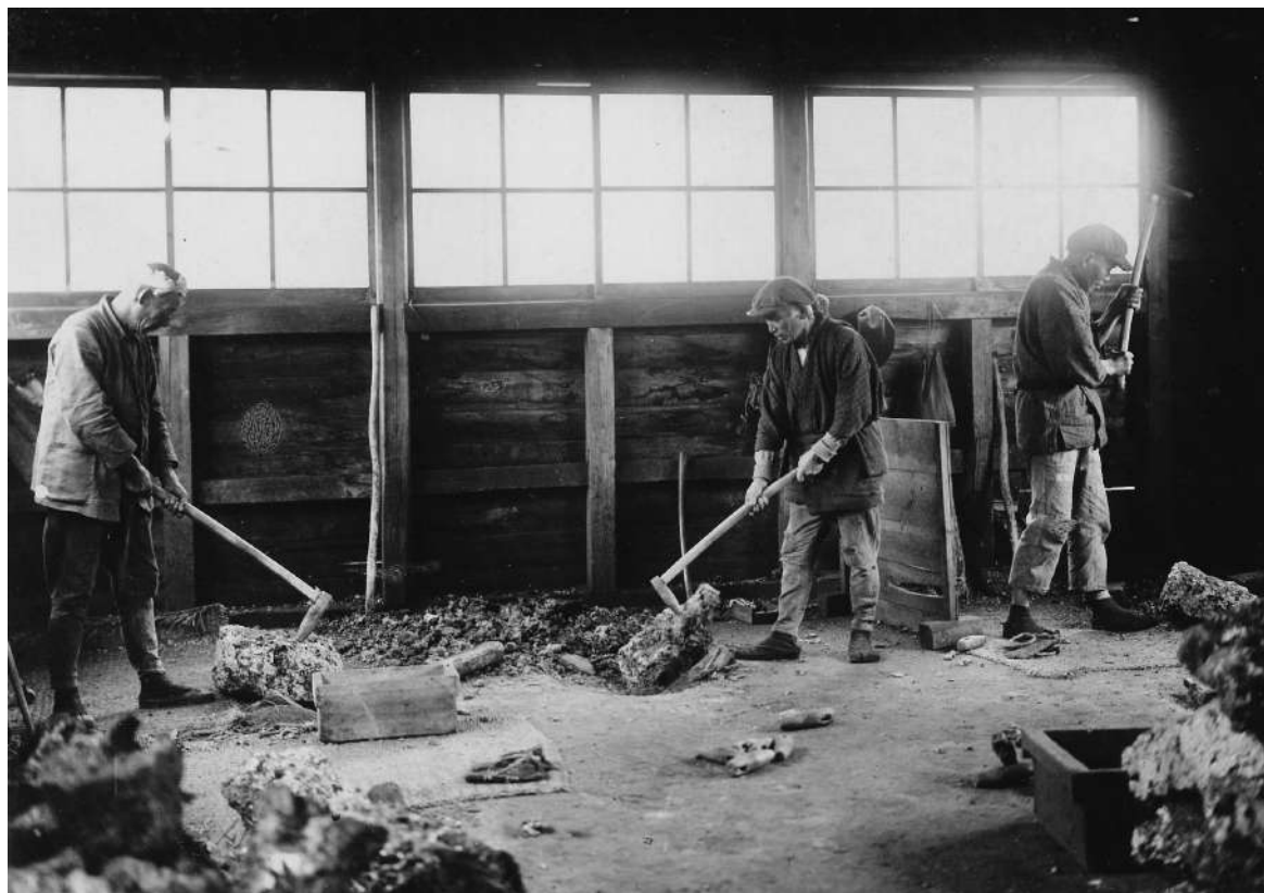
図10 靖国鉦の鋼造り作業（島根県教育委員会提供）
